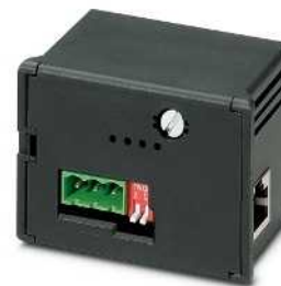
Шлюз Ethernet со встроенным веб-сервером
